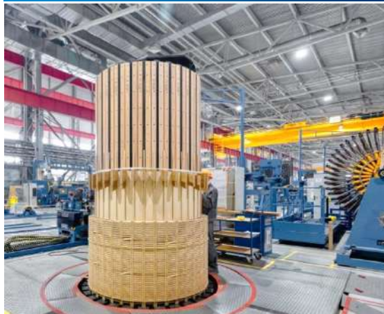
Намоточные станки (LAE, Италия)
